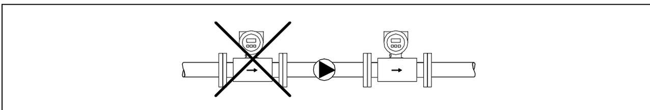
Рис. 7: Монтаж насосов
