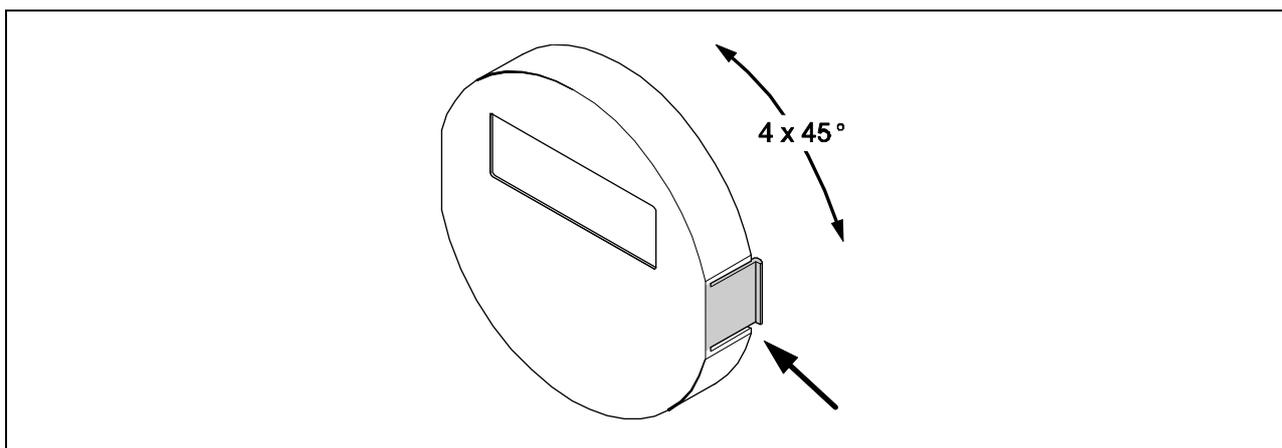
Рис. 21: Поворот местного дисплея (корпус полевого блока)
