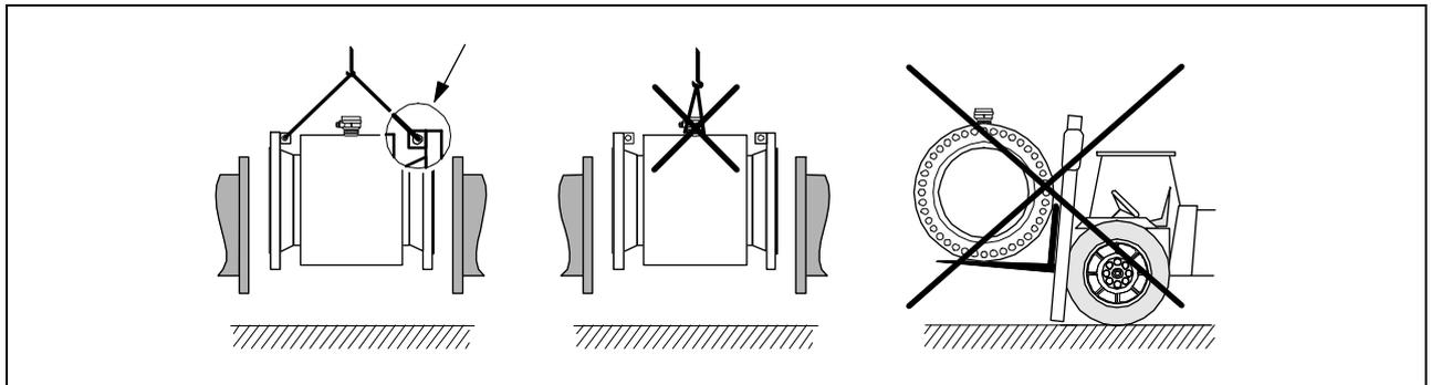
Рис. 5: Транспортировка датчиков с ДУ > 300 (12")
