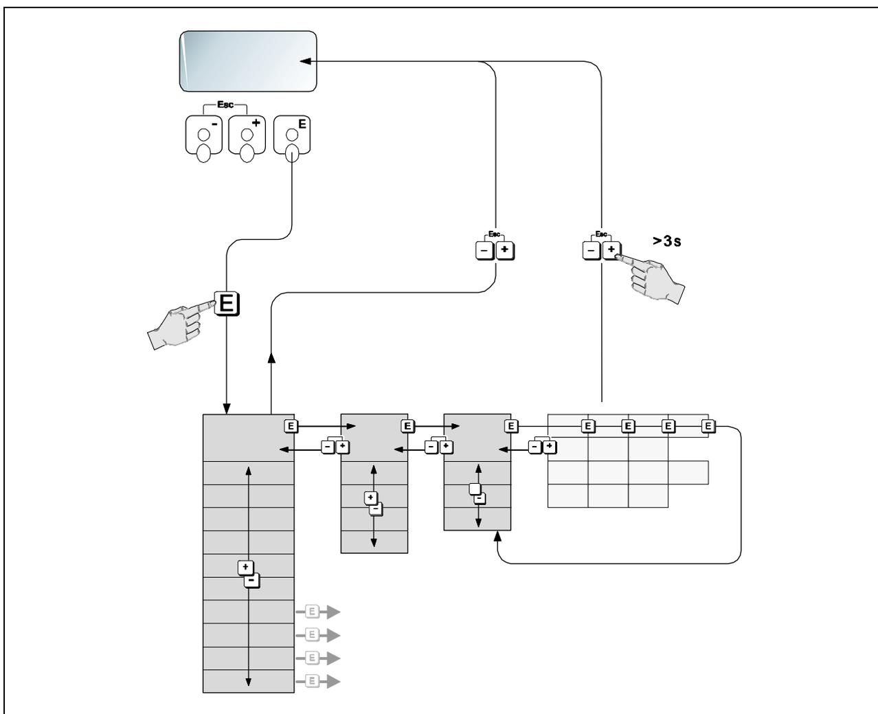
Рис. 39: Выбор функций и конфигурирование параметров (матрица функций)
