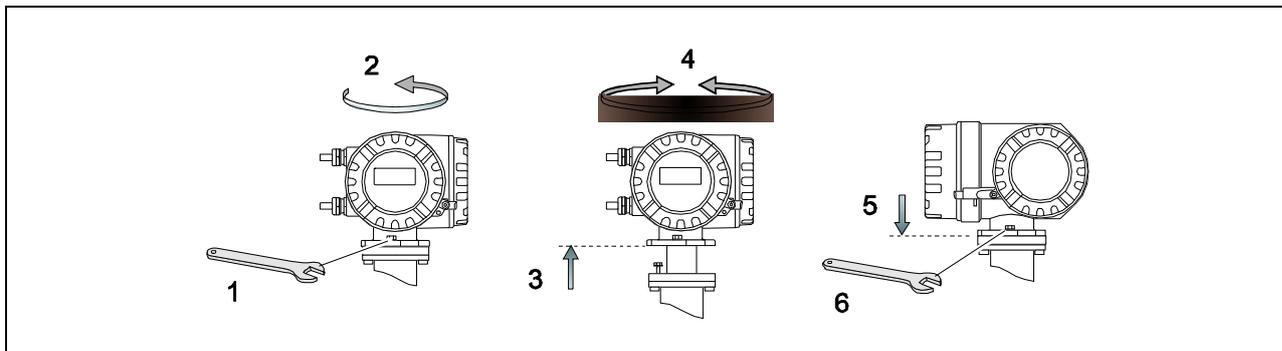
Рис. 20: Вращение корпуса преобразователя (алюминиевый корпус полевого блока)
