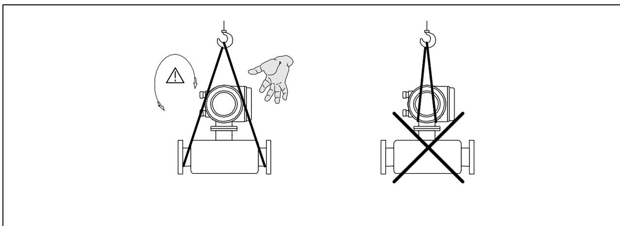
Рис. 4: Транспортировка преобразователя с ДУ ≤ 300/12”
