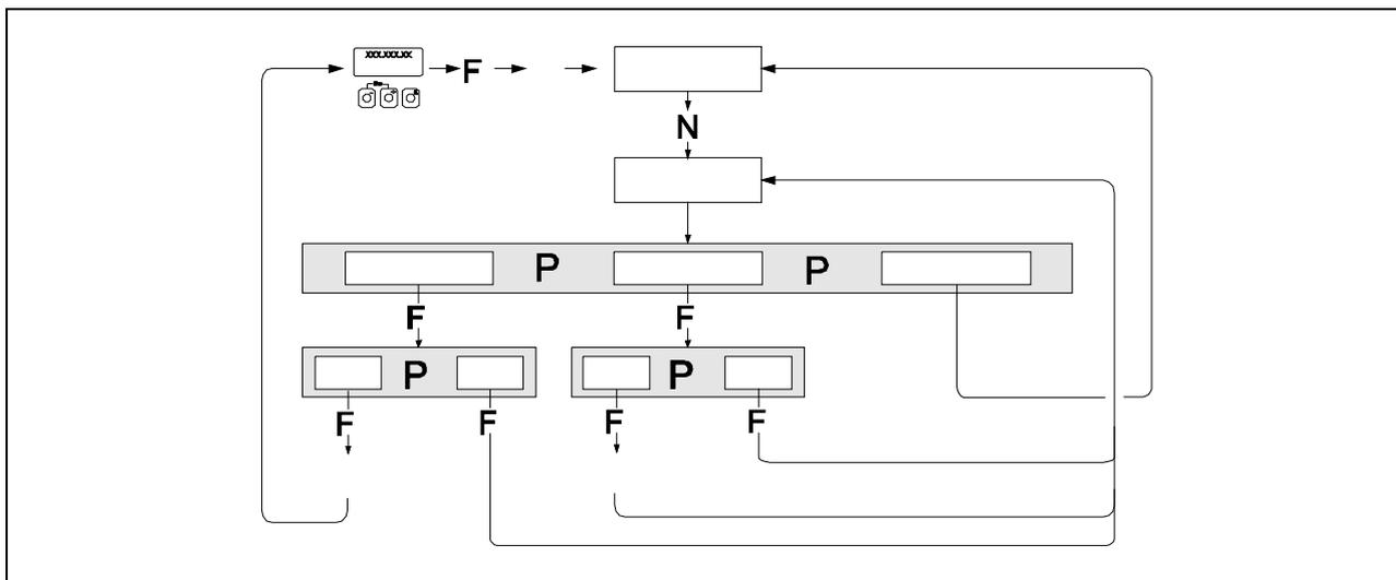
Рис. 45: резервное копирование/передача данных при помощи функции SAVE/LOAD памяти T-DAT
