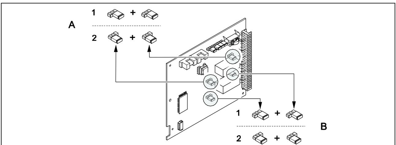
Рис. 50: Конфигурирование релейных контактов (NC/NO) для модульной платы с фиксированной структурой модулей.
